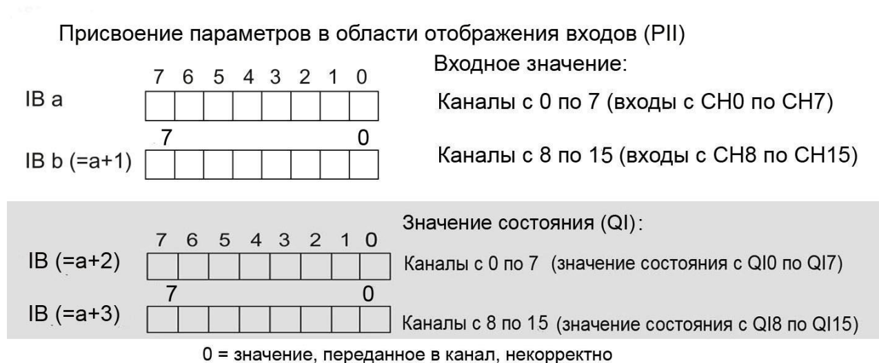
Рисунок 4-1 Пространство адресов для конфигурации модуля в режиме 16-канального входа DI 16x24...125VUC HF QI с оценкой состояния
