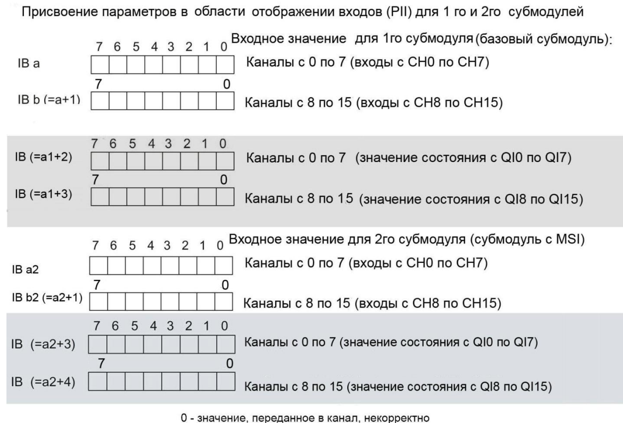
Рисунок 4-3 Пространство адресов при конфигурации модуля DI 16x24...125VUC HF MSI
